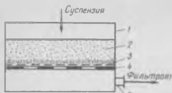
Рис. 10-15. Открытый нутч-фильтр: 1 - корпус; 2 - суспензия; 3 - фильтровальная перегородка; 4 - пористая подложка; 5 - штуцер для выхода фильтрата, соединенный с вакуум-насосом
