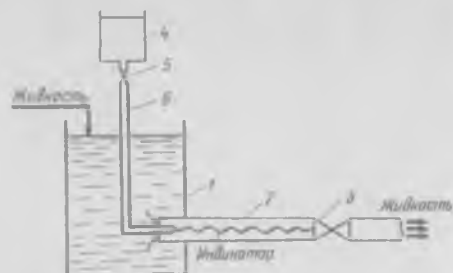
Рис. 3-3. Прибор Рейнольдса для изучения режимов движения жидкости: 1 - сосуд; 2 - стеклянная труба; 3, 5 - краны; 4 - напорная емкост; 6 - капиллярная трубка
