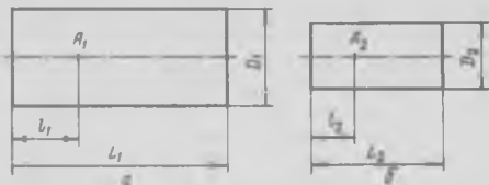
Рис. 4-1. К определению условий подобия природы (а) и модели (б)
