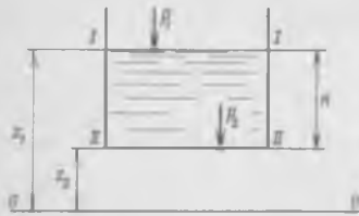
Рис. 6-1. К основному уравнению гидростатики
