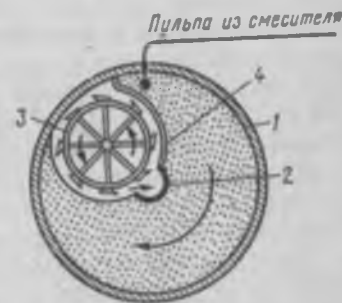
Рис. 12.3. Суперфосфатная камера непрерывного действия (план):
