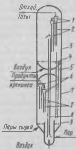
Рис. 9.14. Реактор крекинга в кипящем слое катализатора:
