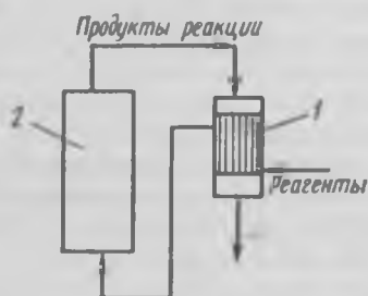
Рис. 9.1. Принцип рекуперации теплоты продуктов реакции или отходящих газов:
