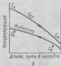
Рис. 2.7. Изменение концентраций при абсорбции компонента газовой смеси жидкостью в башне с насадкой:
