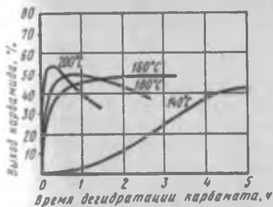
Рис. 12.6. Зависимость выхода карбамида от времени дегидратации карбамата, при различной температуре
