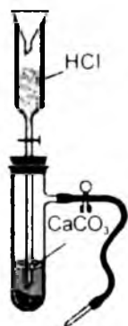
Рис. 78. Установка для получения углекислого газа.
