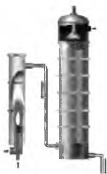
Рис. 62. Получение HCl в промышленности.
