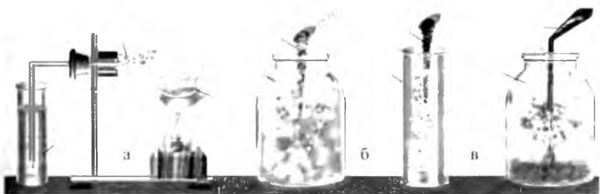
Рис. 61. Химические свойства хлора: а) реакция с натрием; б) реакция с медью; в) реакция с железом; г) реакция с сурьмой.
