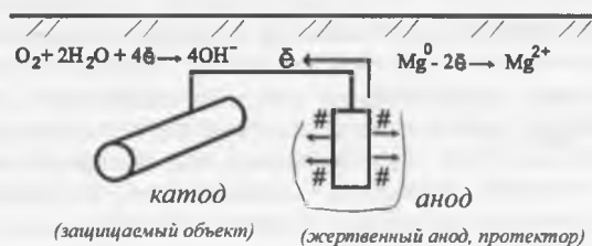
Рис. 11.10. Гальваническая защита с использованием магниевого анода
