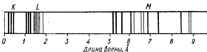
Рис. III.9. Спектр характеристического рентгеновского излучения. К-, L-, M-спектральные серии.
