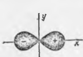
Рис. 17. Схематическое изображение электронного облака 2p -электрона.
