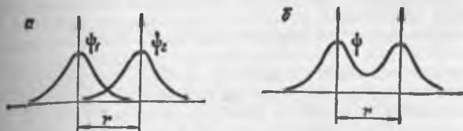
Рис. 43. Схема образования связывающей МО из атомных 1s-орбиталей.
