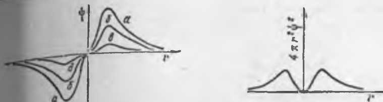
Рис. 15. График волновой функции 2p -электрона.
