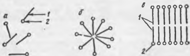
рис. 30. Растворы мицеллярных коллоидов: молекулярный раствор (а), коллоидные растворы со сферическими (б) и пластинчатыми (в) мицеллами.
