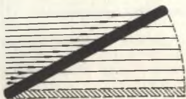
49-расм. Чўзикрок заррача суюкликнинг оқишига кўндаланг жойлашганида суюклик ҳаракатига ҳалал беради.
