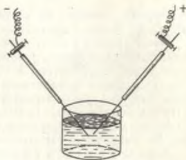
2-расм. Металларни электр ёрдами билан чанглатиб, коллоид эритма ҳосил қилиш схемаси.
