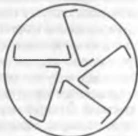
25-расм. Тегирмон охириги бўлмасининг радиал тусиқлари схемаси.
