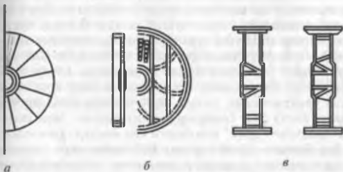
23-2-расм. Камералараро түсиқлар: a — бир қаватли; б — элеваторли икки қаватли; в — сепараторли икки қаватли.
