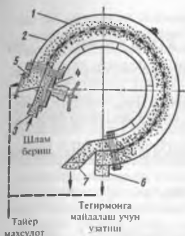
22-расм, в. Ёйсимон галвир схемаси: 1 — корпус; 2 — ёйсимон панжарали тур; 3, 5, 6, 7 — патрубок; 4 — клапан.
