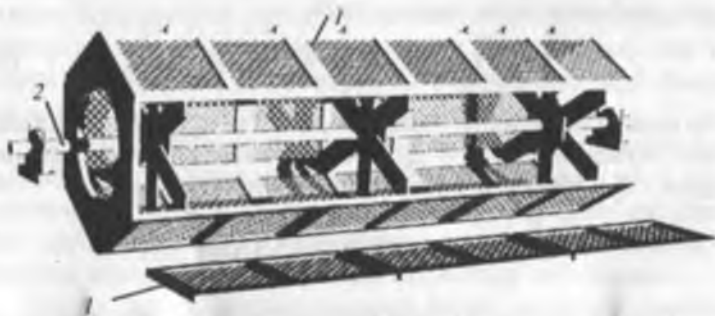
22-рasm, б. Кўп қиррали барабанли ғалвир: 1-рама; 2-уқ.
