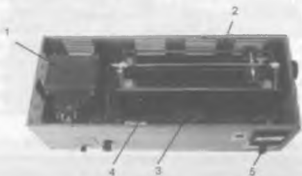
5.5-rasm. SL-13 stiloskopi generatorining qo'shimcha elektr manbaining umumiy ko'rinishi: 1-transformator, 2-reostat, 3-magnit ulovchi, 4-kondensatorlar to'plami, 5-ampmetr shkalasini o'zgartiruvchi dasta
