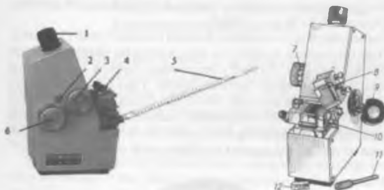
7.3-rasm. IRF-454 refraktometrining ko'rinishi: 1-okulyar;
