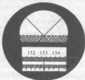
7.4-rasm. IRF-454 refraktometri okulyarining ko'rish maydoni
