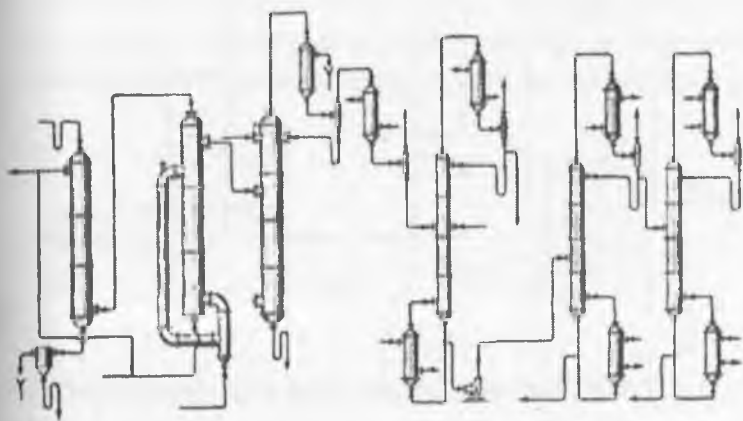
12.1-rasm. Etilenxlorgidrin usuli bo'yicha etilenoksidi olish tizimi
