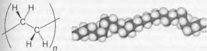
9.2-rasm. Polietilenning molekulyar tuzilishi.
