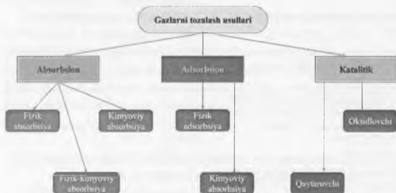
4.1-rasm. Gazlarni nordon komponentlardan ajratish.
