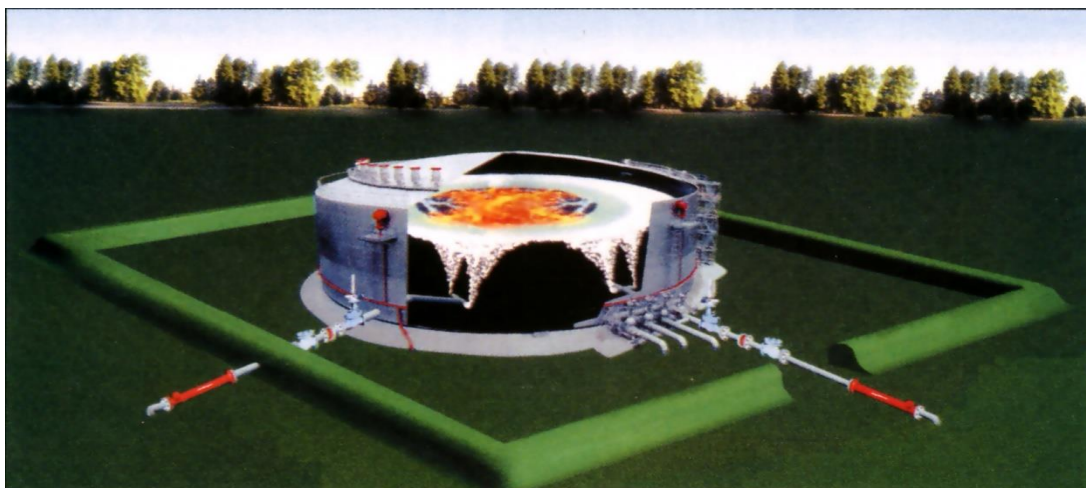
Рисунок-6.6. Тушение пожара при помощи пены, автоматически подаваемой на поверхность горящего факела через нефтепродукт, находящийся в резервуаре
