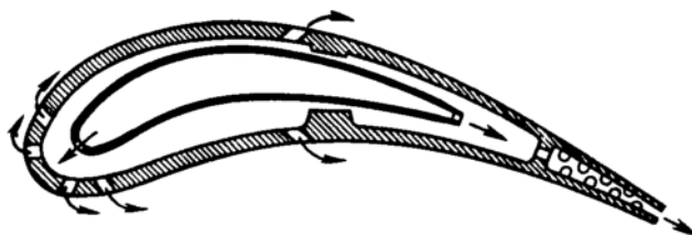
Рис. 3.13. Поперечное сечение интенсивно охлаждаемой сопловой лопатки
