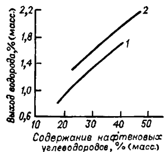
Рис. 62. Зависимость выхода водорода от содержания нафтеновых углеводородов в сырье:
