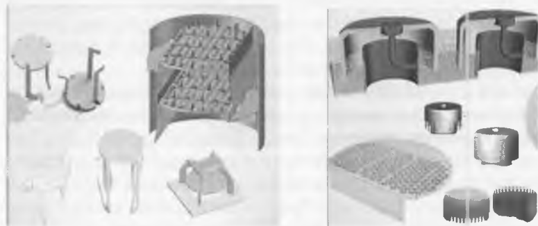
14.7-rasm. Klapanli va qalpoqchali kontakt qurilmalari
