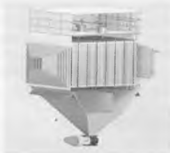
5.15-rasm. Elektrofiltrning sxemasi:
