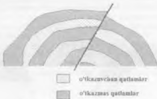
1.2-rasm. Tektonik to'silgan uyum.
