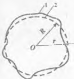
V.9- rasm. Planda doira shaklidagi neft konining sxemasi: 1-neftlilikning shartli chegarasi; 2-neftlilik chegarasining radiusi R aylanaga approksimatsiyasi.
