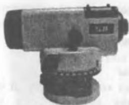
Рис. 3.52. Нивелир оптический «NL 20»
