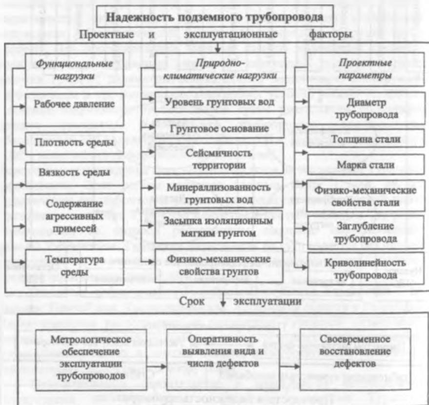
**Рис. 2.2.** Факторы влияющие на надежность подземных газонефтепроводов в условиях динамичности влагосолесодержания грунтов.
