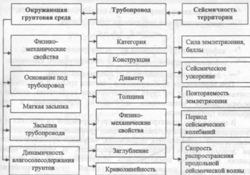
Рис. 2.6. Схема выбора параметров подземного магистрального газонефтепровода, определяющих однородность условий эксплуатации.
