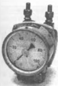
Дифференциальные манометры (дифманометры) сифонные предназначены для измерения:
