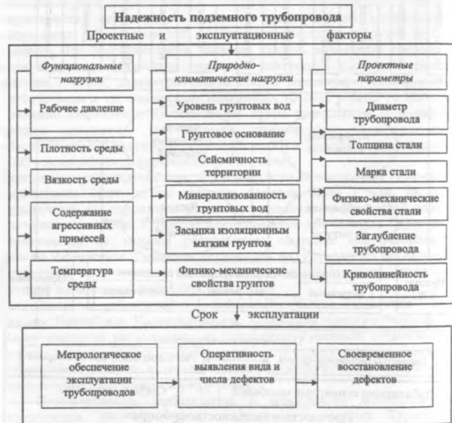
**Рис. 2.2.** Факторы влияющие на надежность подземных газонефтепроводов в условиях динамичности влагосодержания грунтов.
