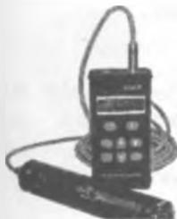
Позволяет определить реальную плотность и температуру жидкостей в ж/д цистернах, бензовозах и резервуарах для нефтепродуктов (до 6 м). Портативный погружной плотномер DM-230.1B используется для контроля качества и широкое использование получил в нефтехимической отрасли для товарного учета нефти и нефтепродуктов при транспортировке и хранении.
