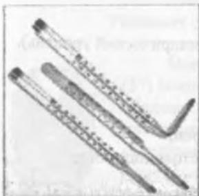
Температуру измеряют при помощи термометров. Термометры, предназначенные для измерения температур выше  $630^{\circ}\text{C}$ , называют пирометрами.
