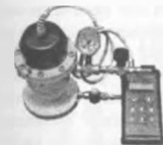
Уникальный цифровой плотномер «LPGDi» - специальная разработка компании LEMIS для измерения реальной плотности и температуры, расчета приведенной плотности и массовой доли пропана и п-бутана в газе в процентах (рассчитанной согласно стандарту ГОСТ28656 для идеальной смеси двух газов пропана и п-бутана) сжиженных нефтяных газов (пропан, бутан).
