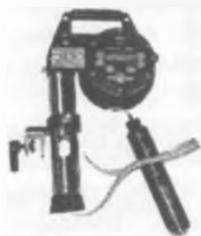
Рис. 3.122. Портативный погружной плотномер «DM-230.2B».
