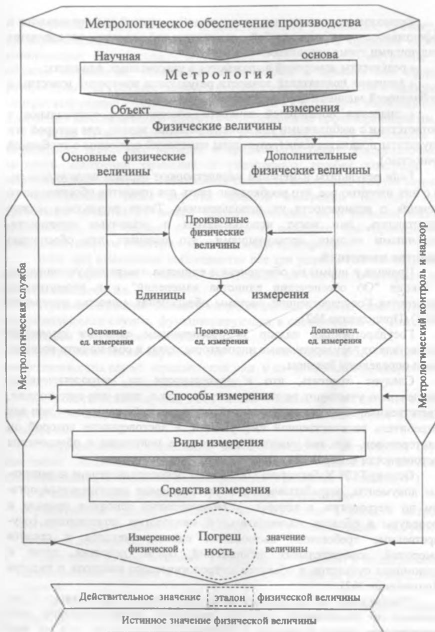
**Рис.1.1. Блок – схема курса «Метрологическое обеспечение производства».**
