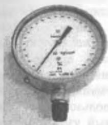
Рис. 3.90. Манометр образцовый типа МО.
