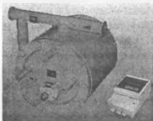
Счетчик «СКЖ» состоит из камерного преобразователя расхода (КПР) и блока вычислителя массы БЭСКОЖ. КПР счетчика СКЖ состоит из корпуса и, в зависимости от типоразмера, одного или двух блоков измерительных. Для работы счетчика СКЖ необходимо присутствие в его корпусе свободного газа. Поэтому счетчик наиболее
