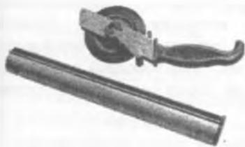
Рулетки с лотом «P10УЗ» и «P20УЗ» предназначены для измерения высоты уровня нефтепродуктов в емкостях и резервуарах.
