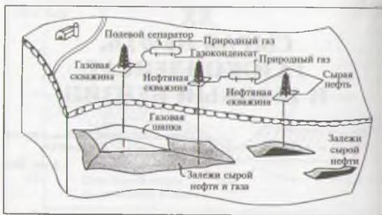
Рис. 20.1. Добыча нефти на промыслах.
