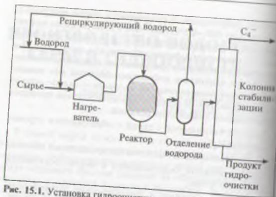
Рис. 15.1. Установка гидроочистки.
