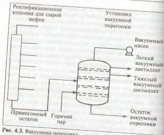
Рис. 4.3. Вакуумная перегонка.
