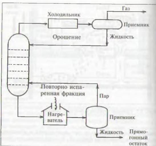
Рис. 3.8. Орошение и повторное испарение.
