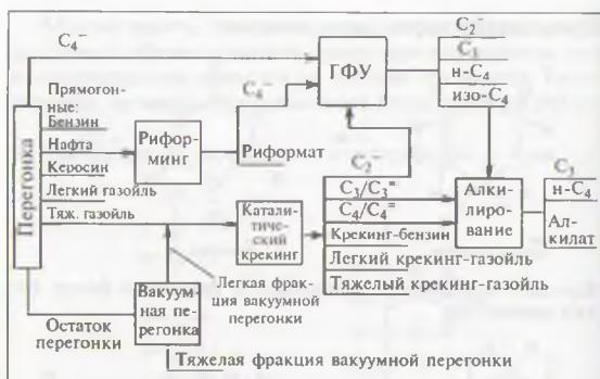
Диаграмма 3. Схема переработки нефти, включающая каталитический риформинг.
