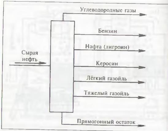
Рис. 3.3. Перегонка нефти.
