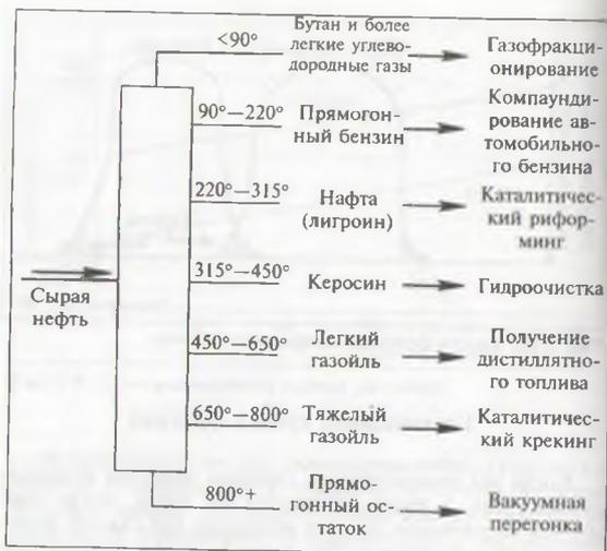
Рис. 3.11. Перегонка нефти и назначение продуктов.
