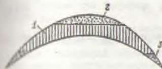
3.14 - расм. Иккиламчи газ қалпоғли нефть конининг схемаси: 1 - нефть; 2 - газ қалпоғи; 3 - чегара ташқарисидаги сув.
