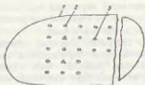
14-расм. Тўққиз нуктали ишлаш системасида бурғ қудукларини жойлаштириш нефтликнинг шартли чегараси; 2 ва 3-мос равишда олиш ва ҳайдаш бурғ қудуклари.
