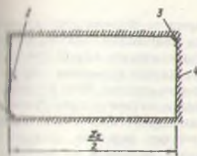
6-расм. Бир қаторли ишлаш системасида бурғ қудуқларини жойлаштириш: 1-нефтлиликнинг шартли четараси; 2-хайдаш бурғ қудуқлари; 3-олиш бурғ қудуқлари.
