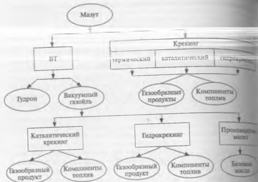
Рис. 7.3. Схема возможных вариантов переработки мазута на НПЗ
