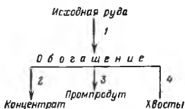
Рис. 2.12. Принципиальная схема обогащения монометаллической руды с выделением трех продуктов
