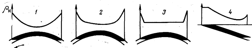
Рис. 39. Принципиальная схема изменения плотности нефти по объему залежей (по А. А. Карцеву)
