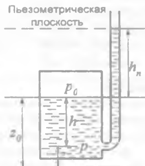
Рис. 2.1. Закрытый сосуд с покоящейся жидкостью (справа показана вертикальная открытая трубка - пьезометр)
