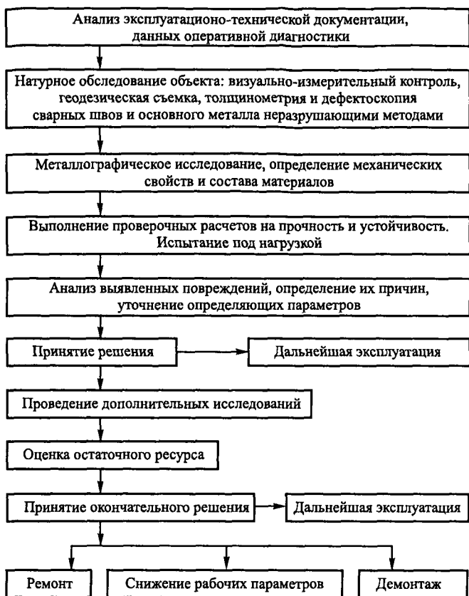
Рис. 1.4. Алгоритм технического диагностирования
