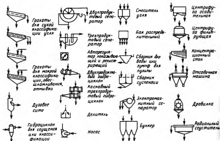
Рис. 18. Условные обозначения, принятые в схемах обогащения углей
