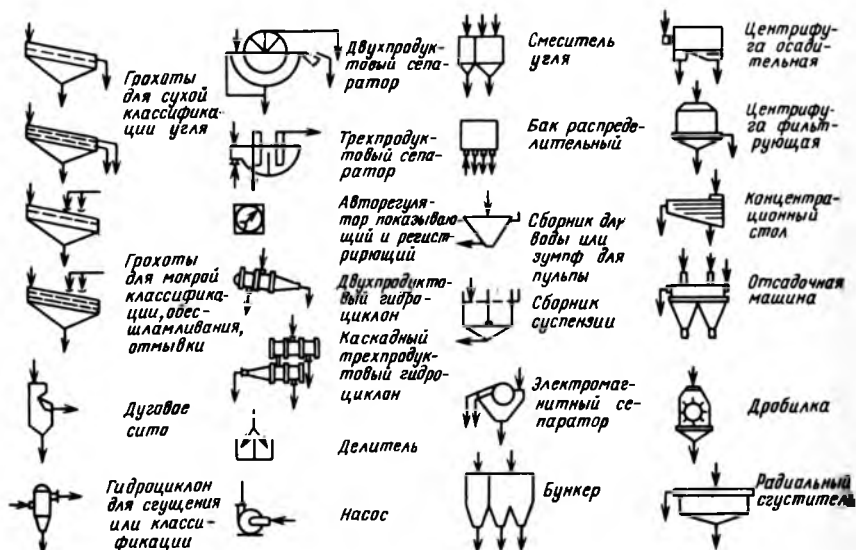
Рис. 18. Условные обозначения, принятые в схемах обогащения углей
