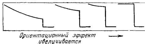
Рис. 9.15. Зависимость ориентационного эффекта от характеристик, определяющих долю в потоке
