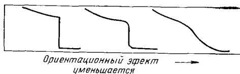
Рис. 9.16. Зависимость ориентационного эффекта от дисперсионных членов
