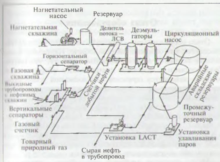
Рис. 11.7. Общая технологическая схема промысла
