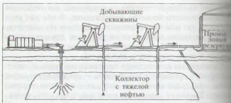
Рис. 15.2. Использование совместного производства тепла и электроэнергии для паровой пропитки коллектора с тяжелой нефтью
