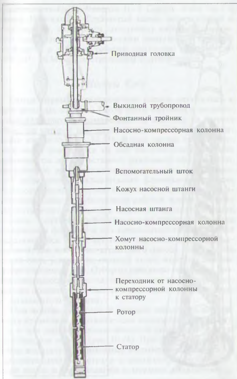
Рис. 10.21. Насос с поступательным движением полости
