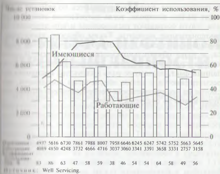
Рис. 1.13. Использование установок для ремонта скважин в США
