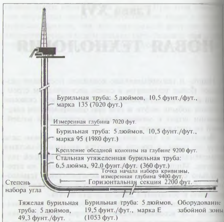
Рис. 16.1. Типовая горизонтальная скважина (вид на бурильную колонну)
