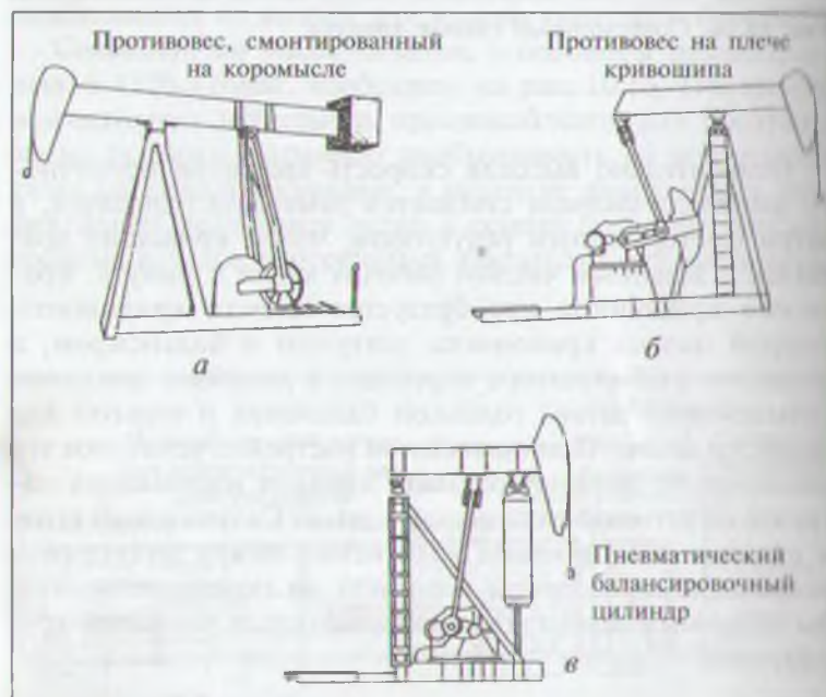
Рис. 10.17. Типы балансировки качалок: а — коромысловая, б — кривошипная и в — пневматическая
