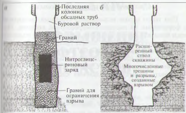
Рис. 13.6. Нитроглицериновая интенсификация пласта: до (а) и после (б) воздействия
