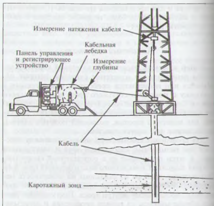
Рис. 6.4. Работа с каротажным зондом
