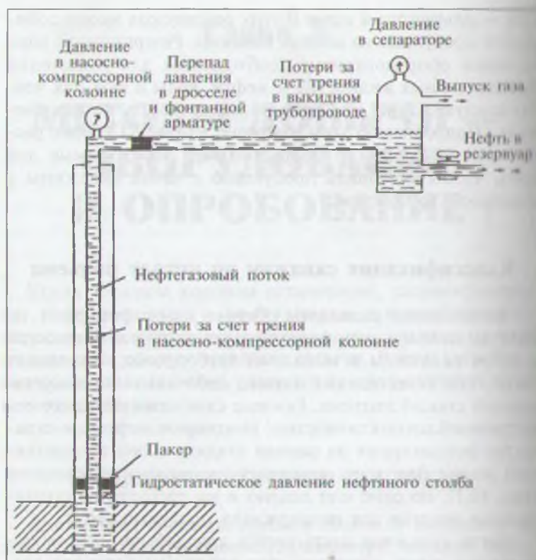
Рис. 10.1. Схематическое изображение фонтанирующей скважины с достаточным давлением для подъема нефти на поверхность
