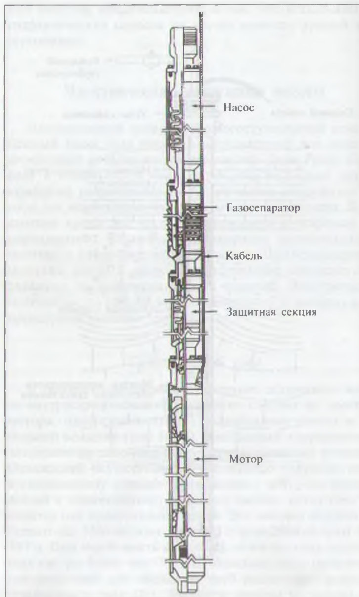
Рис. 10.33. Разрез погружного насосного узла
