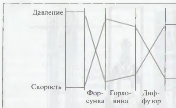
Рис. 10.31. Профили давления и скорости внутри гидравлического струйного насоса
