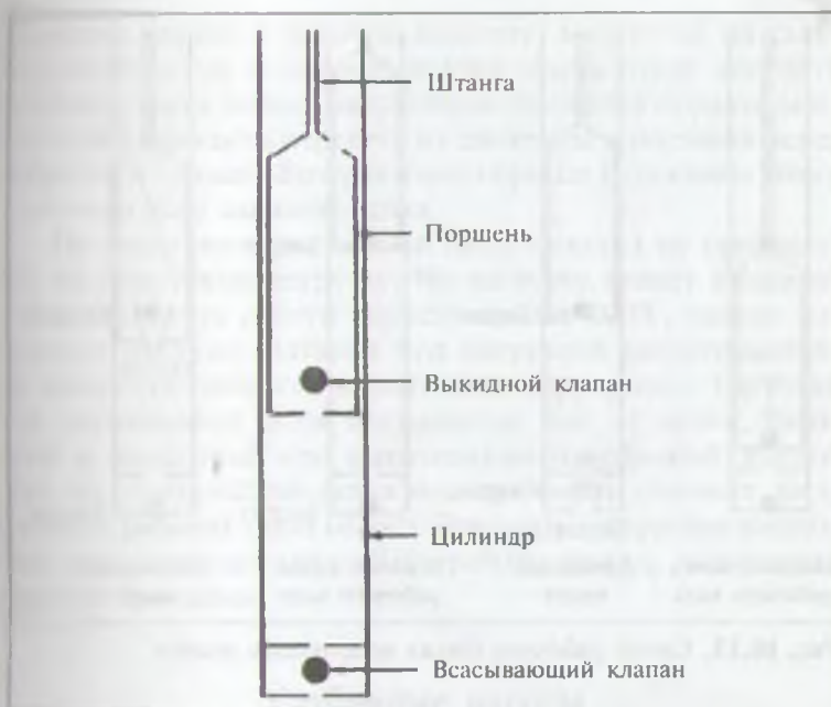
Рис. 10.12. Схематическое изображение простого штангового насоса
