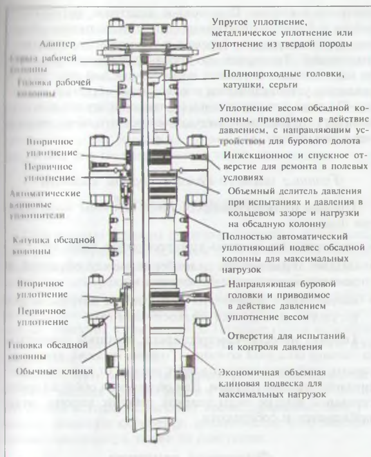
Рис. 11.2. Части оборудования устья скважины (предоставлено Gray Tool Co.)
