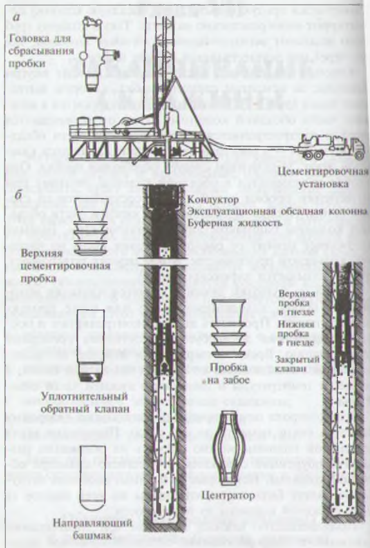
Рис. 7.1. Типовая схема цементирования после постановки обсадной колонны: а — цемент закачивают в скважину; б — эта операция закончена и цемент оставлен для затвердевания (собр. Halliburton)
