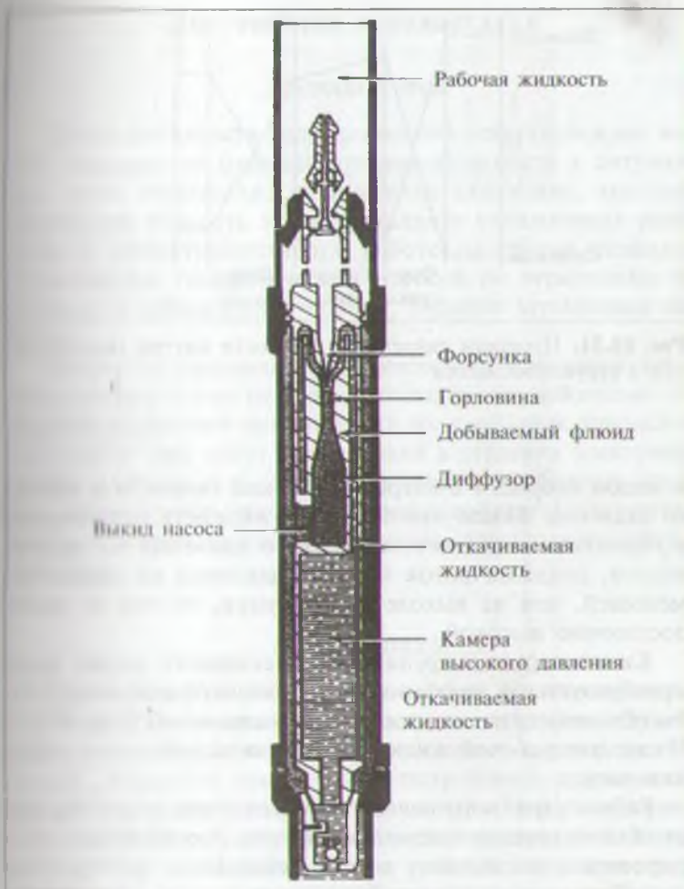
Рис. 10.30. Безобсадный гидравлический струйный насос
