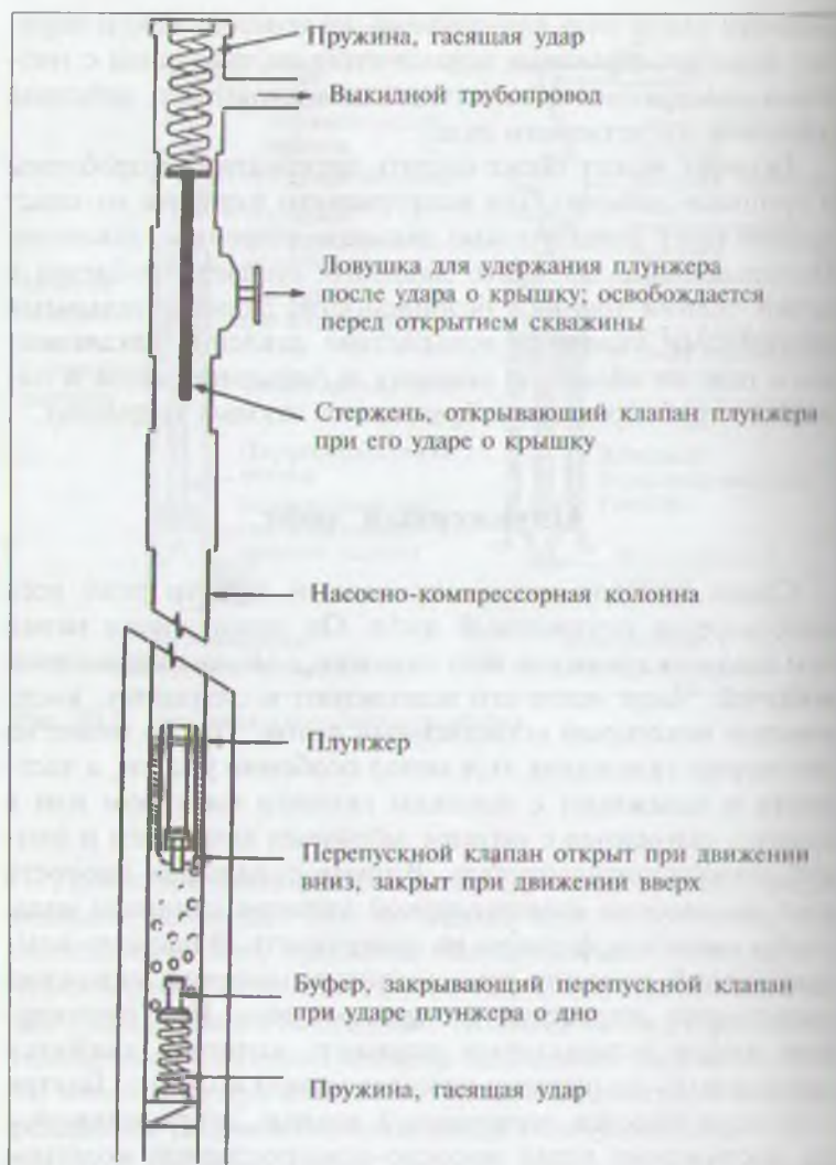
Рис. 10.9. Основные части плунжерного подъемника
