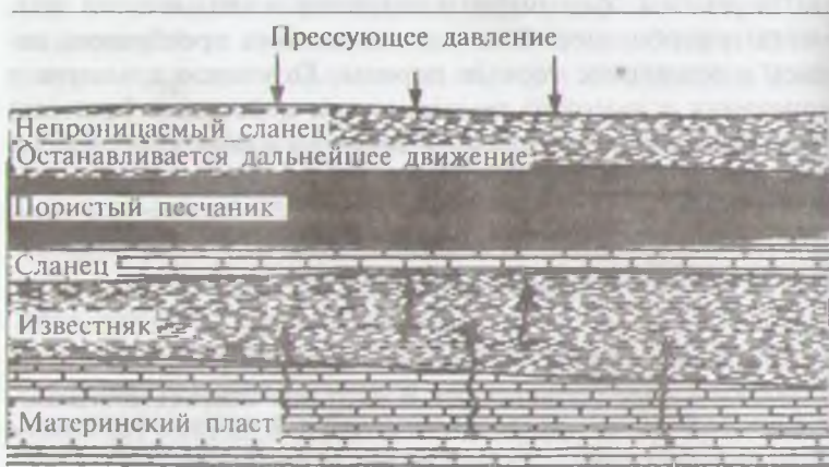
Рис. 3.2. Масса вышележащих слоев горной породы сдавливает подстилающий слой на дне моря, выталкивая углеводороды из материнского пласта вверх, в породу-коллектор
