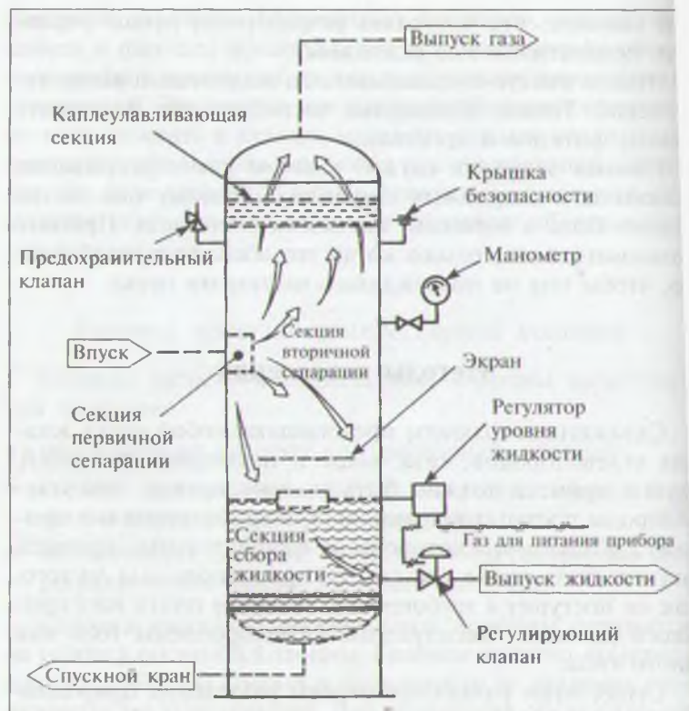
Рис. 11.3. Вертикальный двухфазный газосепаратор
