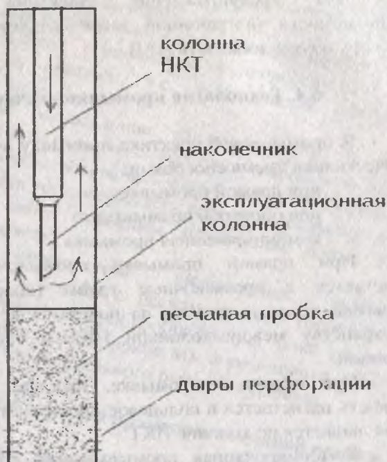
Рис.5. Схема размыва песчаной пробки при прямой промывке.
