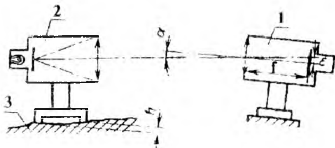
11-rasm. To'g'ri chiziqlikni o'lchashning kollimatsion usuli.
