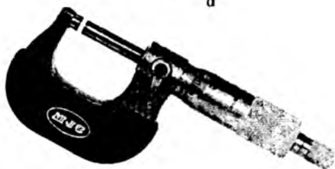
17-rasm. Silliqlik mikrometr: a) 0-25 mm li mikrometr sxemasi; b) bandidagi shkala va baraban bo'yicha sanash; d) 25-30 mm li mikrometrning umumiy ko'rinishi.
