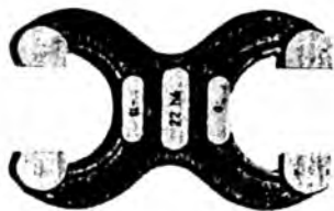
5-rasm. Vallarni nazorat qilish uchun kalibrlar:
