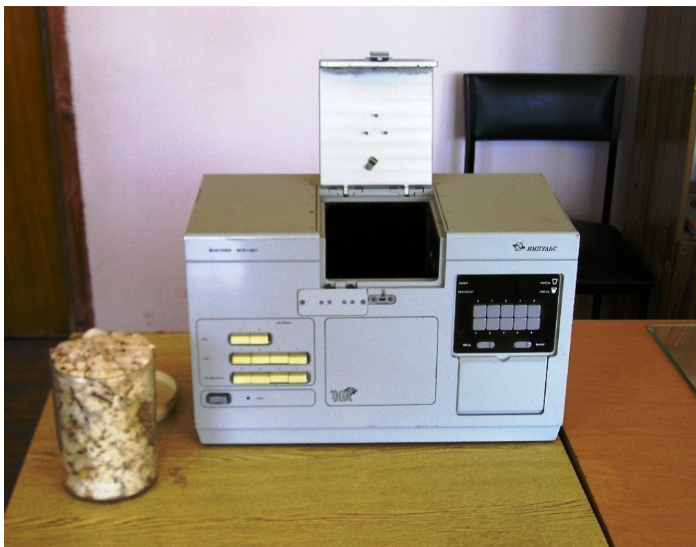
14-rasm. Sochiluvchan va tolali materiallar uchun ko'pmaqsadli O'YCH nam o'lchagichning umumiy ko'rinishi
