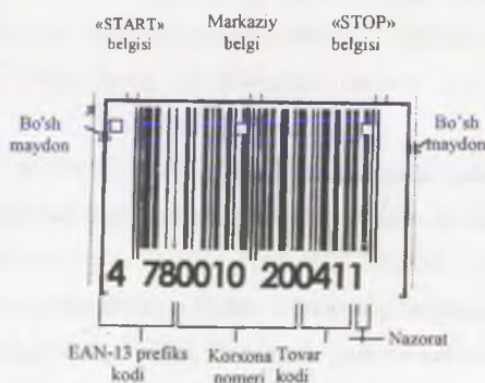
4.1-rasm. EAN-13 kodining strukturasi
