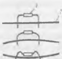
6.2- rasm. Bosma plataning vibratsiyalarida elementlarning chiqishlarining shaklining o'zgarishi: 1 – element; 2 – bosma plata
