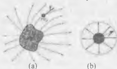
4.1- rasmi. A - musbat test zaryadi zaryadlangan obyektning atrofiga kiritilgan; B – sferik obyektning elektr maydoni
