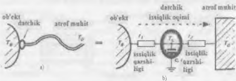
5.13- rasm. Harorat datchigi; (A)- obyekt, tutashtiruvchi kabel bilan issiqlik kontaktida; (B)-ekvivalent issiqlik sxemasi
