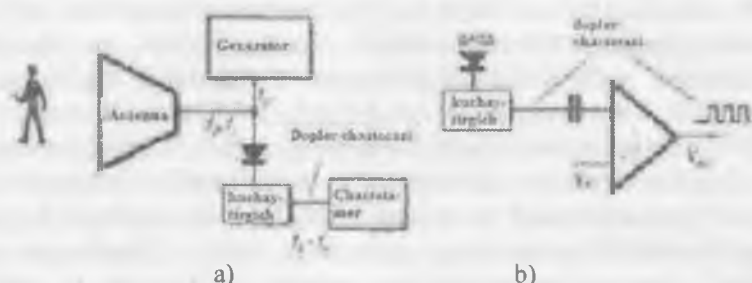
5.1- rasm. O'YuCh mavjud bo'lish detektor: A – Dopler chastotasini o'lchash uchun sxema; B – ostona detektoriga ega bo'lgan sxema
