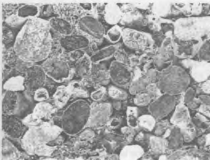
38-rasm. Brekchiya strukturasi fotosurati. Bo'laklari qirrali, sementi karbonatli, bazalli. To'ldiruvchi massa ham qirrali bo'lakchalardan tarkib topgan
