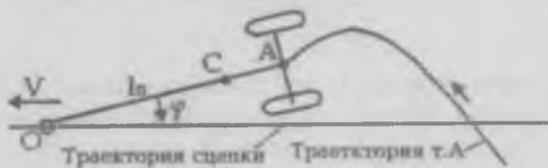
Рис.9 Схема виляний одноосного автомобильного прицепа.
