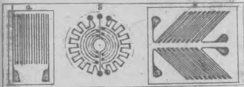
Рис. 24. Примерные формы фольговых тензорезисторов для измерения: а - напряжений сжатия и растяжения; б - давления на мембраны и диафрагмы; в - напряжения кручения.
