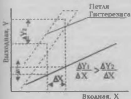
Рис. 19. К понятию чувствительности преобразователя (датчика).
