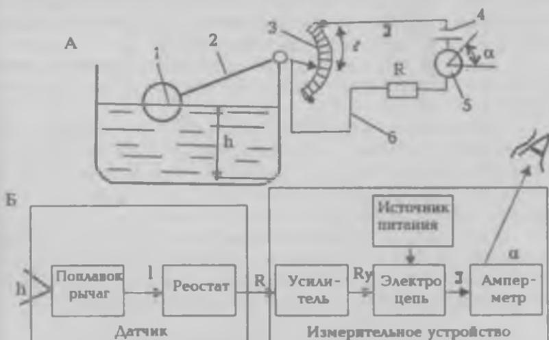
Рис. 18. Схема преобразования измеряемых параметров
