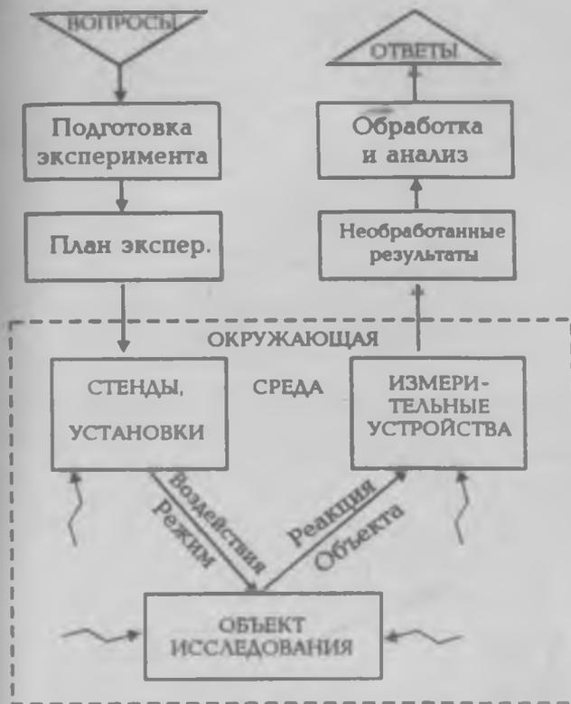
Рис. 16. Экспериментальное исследование как сложная система.
