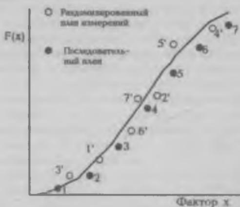
Рис. 41. Систематическая ошибка при неисправности прибора типа "заедания".
