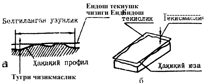
16-расм. Тугри чизицмасликни ва нотекисиликни аницлаш: а) турричизиги!^маслик; б) нотекислик.
