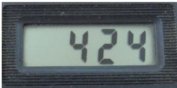
Рис.6.9. Прямое падение напряжения на диоде с барьером Шоттки.
