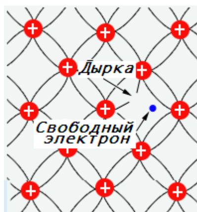
Рис.5.3. Схема соединений атомов полупроводника.
