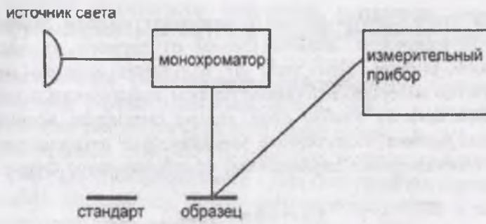
Рис.15.3. Измеряемый образец освещается монохроматическим светом.
