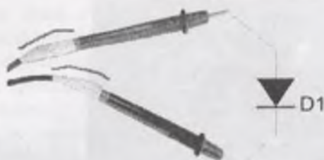
Рис.6.3. На красном щупе «плюс» омметра.
