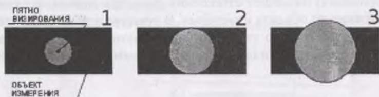
Рис.12.4. Различные варианты положения пятна визирования.
