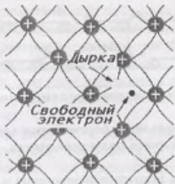
Рис.5.3. Схема соединений атомов полупроводника.
