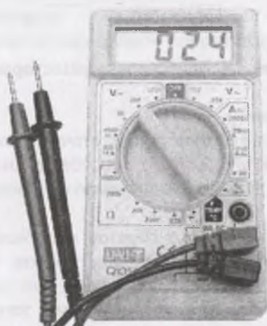
Рис.4.3. Универсальный прибор для измерения электрических параметров – мультиметр.
