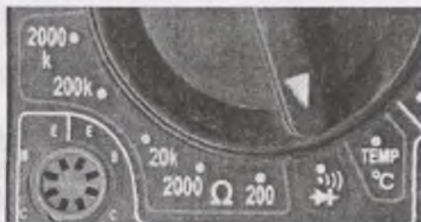
Рис.6.5. Мультиметр в режиме «прозвонки».
