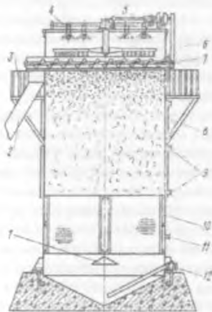
21-rasm. VEKD-5, Bu yerda, 1-ekstraktorga mezgani kirituvchi patrubka; 2-elakli moslama; 3-sovutkich; 4-mezgani bo'shatish shneki; 5-«telpak»ni shnekka uzatadigan xaskash (grabl); 6-ekstraktordan chiqqan mezgani pressga uzatuvchi moslama; 7-sharbat sepadigan moslama; 8-bo'shatish qismining privodi; 9-xizmat ko'rsatish maydoni; 10-tayyor sharbat va oqim sharbatini olish quvuri; 11-sovuq suv kiritish patrubkasi; 12-mezgani chiqarish mosla- masi.
