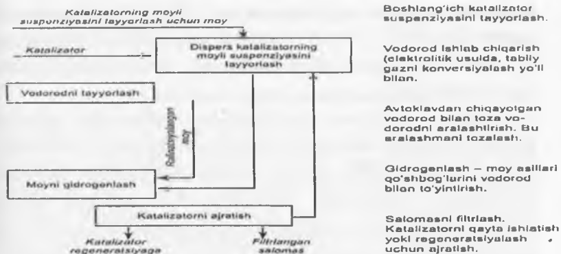
36-rasm. Yog' va moylarni gidrogenizatsiyalash texnologik sxemasi
