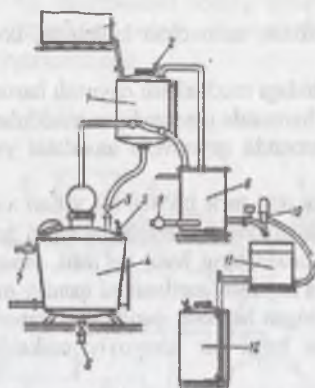
115-rasm. Kon'yak spirit olishda ishlatiladigan sharantiskiy qurilmasini umumiy ko'rinishi: 1-qizdirish sig'imi; 2,5-havo chiqarish jo'mragi; 3-qu'yish jo'mragi; 4-haydash kubi; 6-konyak bardasini bo'shatish jo'mragi; 7-vinoni qizdirish uchun bug' yuboriladigan jo'mrak; 8-sovitgich; 9-sovuq suv kiradigan jo'mrak; 10-spirtni quvvatini ko'rsatuvchi fonar; 11-spirit qabul qilish sig'imi; 12-spirit xomashyosini yig'ish sig'imi.
