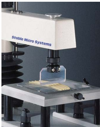
73-rasm. Makaron mahsulotini chidamligini aniqlaydigan uskuna.
