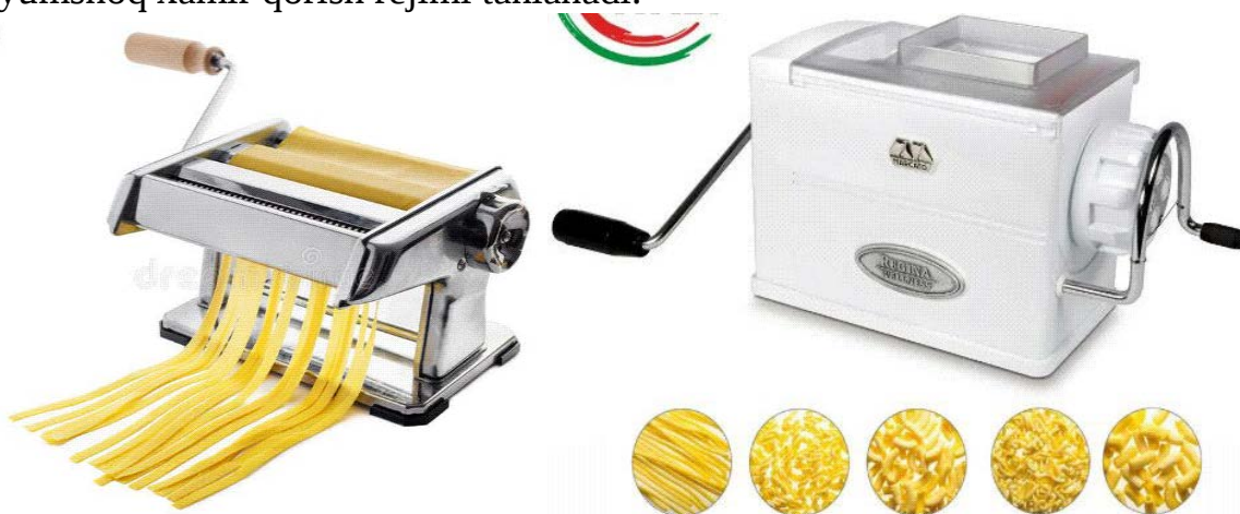
74-rasm. Xamirni yoyib, shakllarga bo'laklovchi uskuna.
