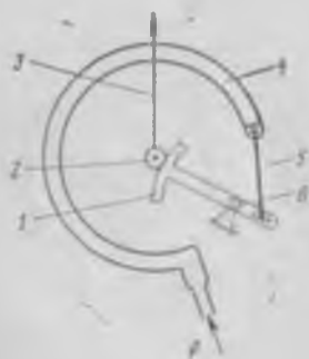
Рис. 21. Прибор с одно- витковой трубчатой пружиной.
