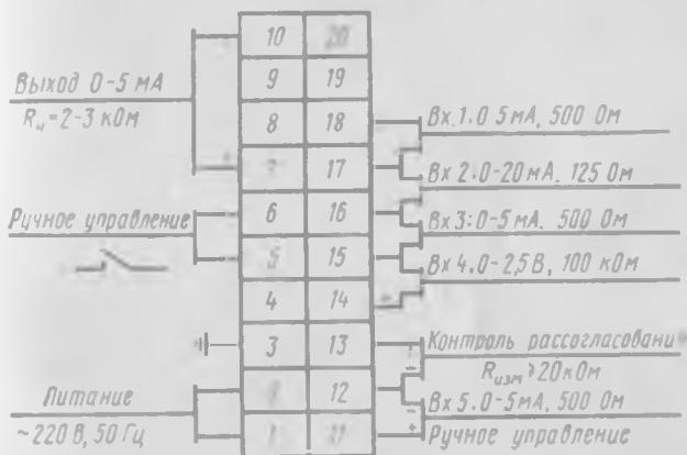
Рис. 62. Схема подключения регулирующего блока типа Р12.
