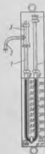
Рис. 4-10. Ртутный двухтрубный мановакуумметр
