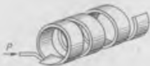
Рис. 4-3. Многовитковая трубчатая пружина
