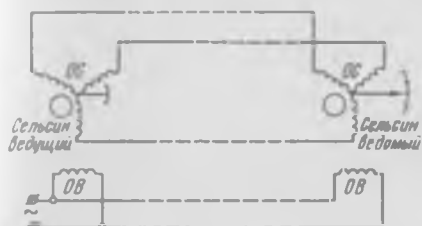
Рис. 2-9. Схема дистанционной передачи с сельсинами
