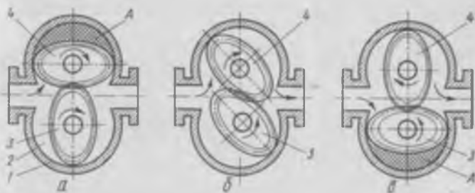
Рис. 5-1. Схема счетчика с овальными шестернями:
