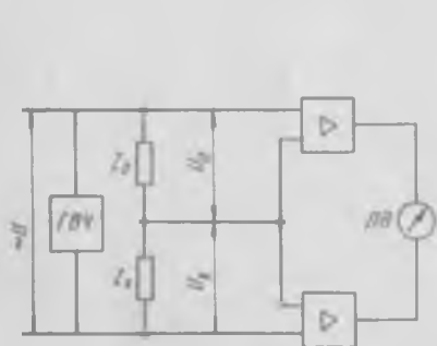
Рис. 7-3. Структурная схема влагомера с емкостным делителем напряжения
