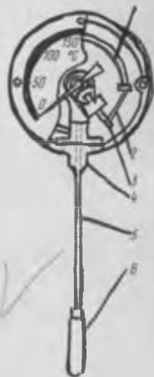
Рис. 3-4. Схема манометрического термометра с трубчатой пружиной
