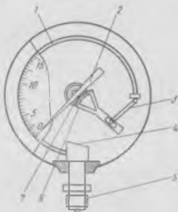
Рис. 4-2. Манометр с одновитковой трубчатой пружиной
