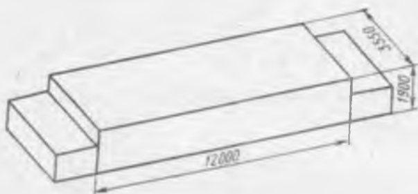
Рис. IX—3. Схематическое изображение печи ПХК-25
