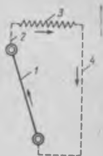
Рис. III—10. Схема обогрева печи паром высокого давления
