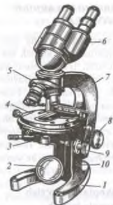
10-rasm. Biologik mikroskop MBR-3: 1—mikroskopning asosi; 2—oina; 3—kronshtein kondensor bilan; 4—predmet stolchasi; 5—revolver obyektivlar bilan; 6—binokulyar tubus; 7—tubus ushlagich; 8—makrometrik vint dastasi; 9—mikrometrik vint dastasi; 10—mik- romexanizm qutisi.
