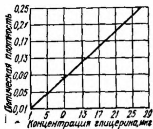
Рис. 26. Калибровочный график зависимости между концентрацией глицерина и оптической плотностью раствора.
