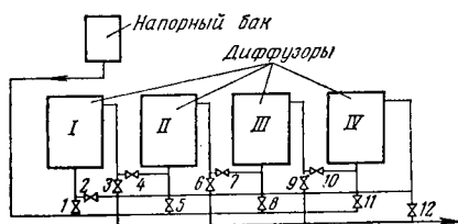
Рис. 33. Схема диффузионной установки.
