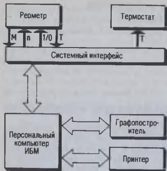
Рис. 7.1. Структурная схема автоматического ротационного реометра «Висколаб» LC10 фирмы «Физика-Местехник»
