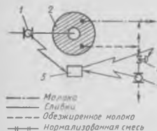
Рис. 24. Схема нормализации молока в потоке:
