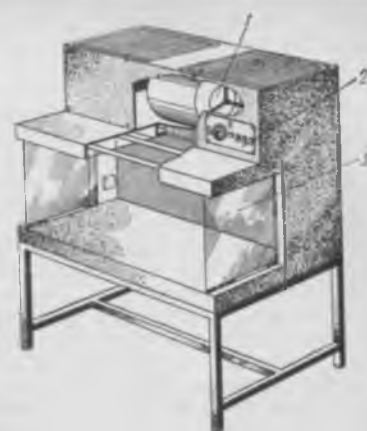
Рис. 8. «Чистый» лабораторный стенд: 1 — вентилятор; 2 — пульт управления; 3 — рабочее пространство
