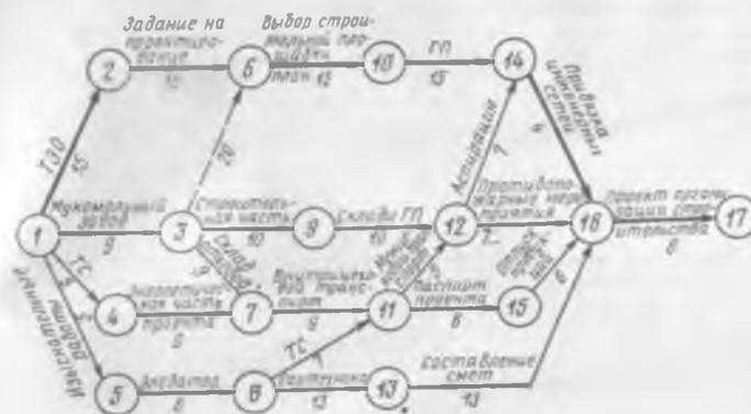
Рис. 45. Исходный сетевой график, ориентированный на работы
