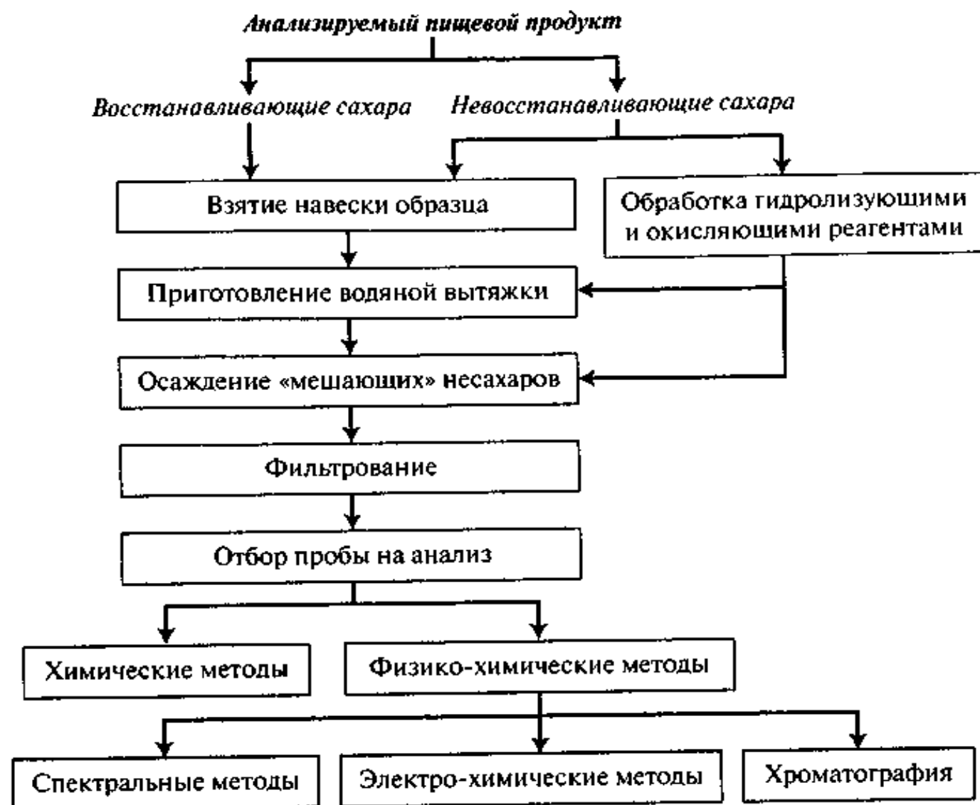
Рис. 2.1. Схема анализа углеводов пищевого сырья и продуктов питания
